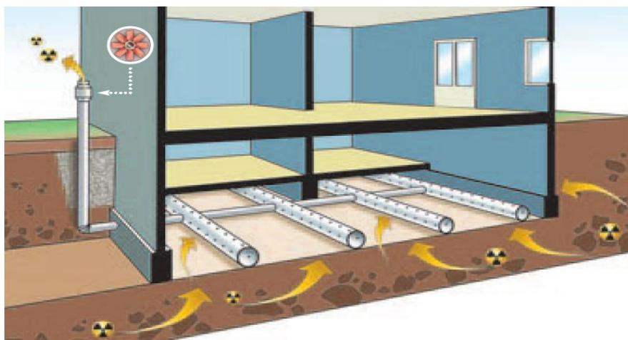
**Figura 4.2.** Sistema di drenaggio realizzato in un edificio con fondazioni a strisce [11]
